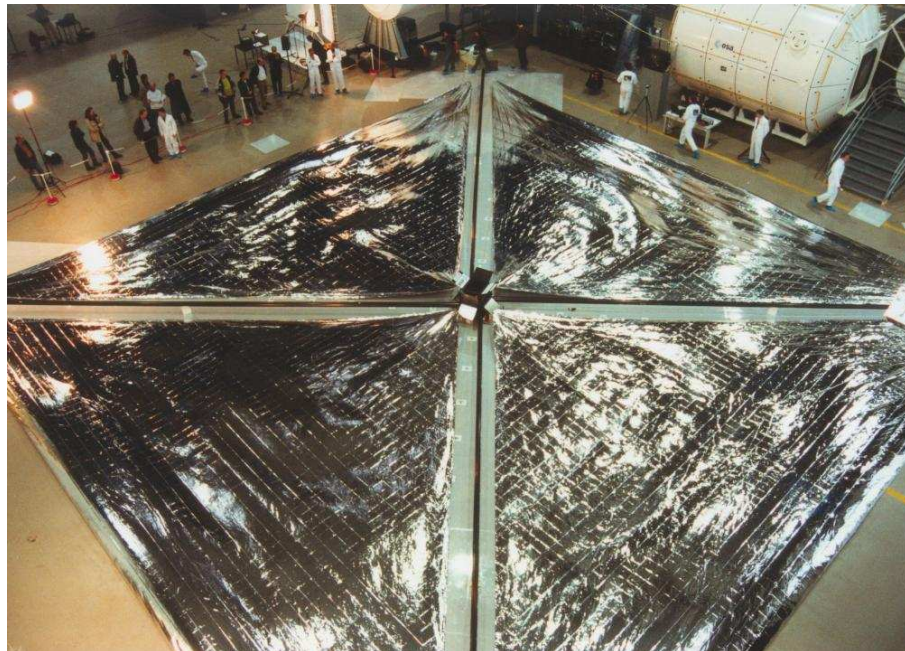
Figura 1.4: Prova di svolgimento di una vela solare quadrata delle dimensioni di 20 m × 20 m condotta nel dicembre del 1999 a Colonia nell'istituto dell'ESA CTC da parte del German Aerospace Center (DLR).
